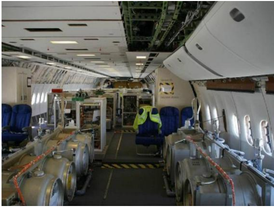
So sieht ein Flugzeug von innen aus – bestückt mit Tanks für eine Sprühaktion
